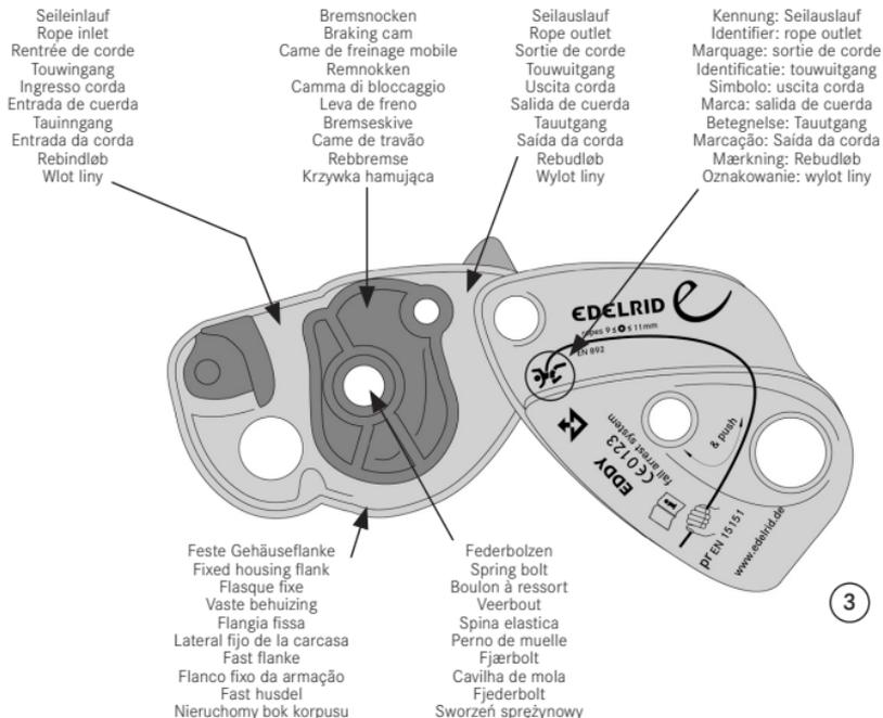
EDDY - Ansicht von oben auf Seileinlauf, Bremsnocke und Seilauflauf
