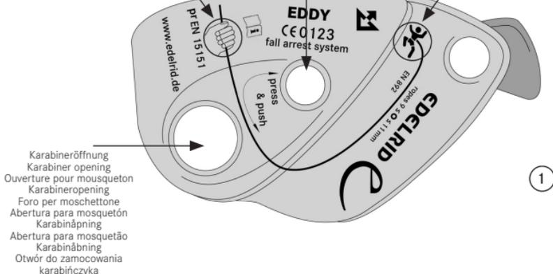
Ansicht der festen Gehäuseflanke mit Steuerhebel - EDDY geschlossen
